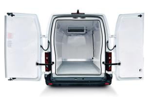
Cette carrosserie est destinée au transport sous température dirigée, en conformité avec la règlementation ATP en vigueur.
