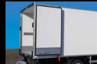
**Hecktür mit 2 (OT2) oder 3 (OT3) Flügeln:** Vollständiger Durchgang zur Erleichterung der Verladung von Paletten. Bei 3 Flügeln (OT3) erleichtert der mittlere Flügel, der links oder rechts aufgehängt sein kann, den Zustieg.
