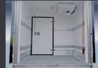
**Feste Quertrennwand:** Je nach Bedarf kann der Kofferaufbau mit einer festen Trennwand in Querrichtung mit Zugangstür zum vorderen Abteil ausgestattet werden.
