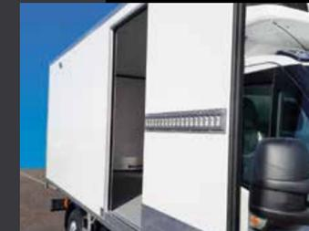
**Seitliche Flügel- oder Schiebetür:** Erhältlich in 2 Breiten und Höhen und in verschiedenen Positionen passend zu Ihren Anforderungen. Die Abdichtung erfolgt durch eine umlaufende mehrlippige Dichtung.
