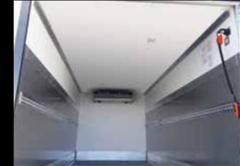
**Interinox-Tailverkleidung:** Wirkt wie eine Panzerung und wird über der Polyester-Verkleidung angebracht. Inox vermindert den Verschleiß durch Abrieb und verstärkt die Seitenwände, die sonst durch Knochen und Fleischware eingerissen oder perforiert werden können.
