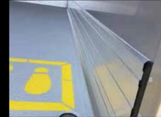
**Spezielscheuerleisten aus Aluminium** aus einem Stück, verklebt und verstärkt durch 6 Rippen zu 5 mm, abgewinkelt, eingelassen, im Boden verklebt und verschraubt. Höhe 300mm, verstärkte Befestigung am Heckeingang mit Dichtungen zur Wärmebrückenunterbrechung.
