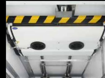
**Mobile Quertrennwand auf 2 Gleitschienen:** Leicht zu öffnen und schließen dank Druckausgleichs- und Gasfederunterstützung. Luftdichte Verbindung durch mehrlippige Silikon-dichtung, geeignet für Minustemperaturen.
