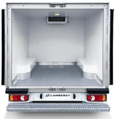
Diese Karosserie dient dem Transport unter geregelter Temperatur in Übereinstimmung mit den geltenden ATP-Richtlinien.
