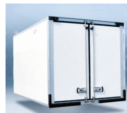
Hecköffnung OT2 PRO (Option mit verringerter Breite 2.09 außen/1.91 Innen)
