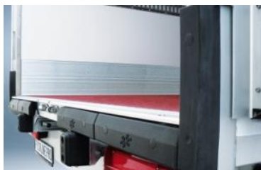
Pack PRO & OT: protection de cadre arrière renforcée (jusqu'à 6 butoirs).
