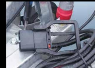
**Anschluss Fahrzeug (Modus «Straße»):** Im Straßenmodus (Option) wird das elektrische Aggregat über eine Steckdose vom Typ «Fenwick» an die Batterie des Zugfahrzeugs, dessen Lichtmaschine für mindestens 90 A ausgelegt sein muss, angeschlossen.
