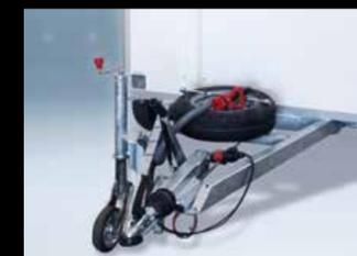
**Aufbauten (serienmäßig):** Sämtliche Anhänger verfügen über einen kompletten Aufbau: Stützrad für das Manövrieren; 2 Stabilisatoren am Heck und Feststellbremse für stationäre Arbeiten oder Parken; Ersatzrad und Kurbel; Steckdose Anhänger (13 Pins) mit abnehmbarem Adapter (7 Pins).
