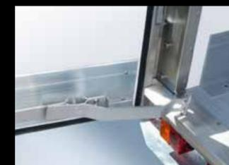
**Türfeststeller:** Die Lamberet-Anhänger sind mit Türarretierung ausgestattet (Kautschuk oder T, je nach Modell). Um Arbeiten in engen. Um Arbeiten in engen Haltezonen zu ermöglichen, ist optional eine Arretierung bei OT2 100\* verfügbar (Photo).
