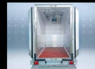
**Hängevorrichtungen für Fleisch (Option):** In der Version Fleischtransport verfügen die Anhänger ab 1300 kg über Einsätze im Dach für die Befestigung eines an Ihre Geschäftstätigkeit angepassten Systems: Feste oder abnehmbare Schienen für Haken, Laufschielen, BI-Schielen, Rohr oder kombiniert. Ergänzend kann der Boden mit rutschfestem, grobkörnigem, rot lackiertem Material versehen werden.
