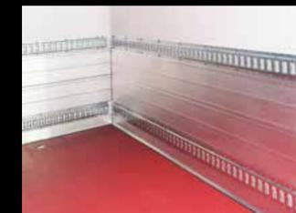
**Halteschienen und Leisten (optional):** Die Aluminium-Leisten schützen die Wände gegen Stöße. Die Halteschienen sichern und stabilisieren Ihre Ware während des Transports (erhältlich in runden «Aero» oder gemischten Perforationen).
