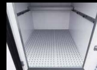
**Bodenrost (Option):** Der Boden ist mit abnehmbaren und durchbrochenen Kunststoffplatten ausgelegt, die leicht abzuwaschen sind, von einer optimierten Lüftung profitieren, den Kontakt zwischen Lebensmitteln und Boden verhindern und die Ladung vor Kondenswasser schützen. Empfohlen im Rahmen eines «HACCP»-Hygienekonzepts.
