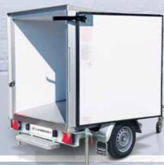
Professionelle Ausführung verfügbar mit den Fahrerlaubnissen B\* oder B96\*! Die Gesamtkonstruktion verbindet einen isothermischen oder kühlenden Kasten sehr hoher Qualität mit einem robusten und stabilen 1-achsigen Chassis. Ein ideales Material für den Transport in einer zusätzlichen spezifischen Kältekammer.
