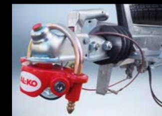
**Diebstahlsicherung (spezifische Option):** Die an der Kupplungsdeichsel angebrachte Diebstahlsicherung sorgt für zusätzliche Sicherheit, indem sie das Ziehen Ihres Anhängers unterbindet.
