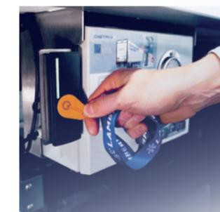
Lamberet presenta el Safety Door Lock, un sistema de cierre automático para asegurar las puertas de las carrocerías frigoríficas. Desbloqueable mediante una TAG RFID personalizada, restringe el acceso de distribución al conductor-repartidor. Existe un control especial para el personal de muelle, así como una solución mecánica en caso de emergencia.
