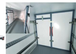
Las normas de seguridad han provocado un aumento constante del peso de los chasis-cabina, reduciendo la capacidad de carga, especialmente en aplicaciones de multi-temperatura. Lamberet responde a este desafío con la nueva cloison ERGOWALL VUL. Articulada lateralmente, más ergonómica y práctica, permite reducir el peso en 60 kg en comparación con las particiones fijadas al techo.
