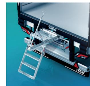
El escalón retráctil Safestair garantiza una subida y bajada segura en camiones rígidos y semirremolques frigoríficos. Su rampa automática ofrece un tercer punto de apoyo, reduciendo el riesgo de caídas. Cumple con las normas VASP para autocaravanas, asegurando una seguridad óptima para los usuarios.
