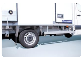
Adaptación del chasis de aluminio
