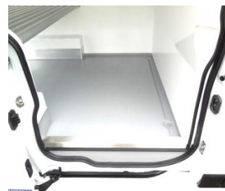
Porte latérale avec protection de seuil inox.
