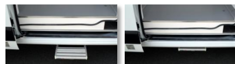
Marche latérale rétractable Quickstep (uniquement associée à la porte latérale - série en version propulsion)
