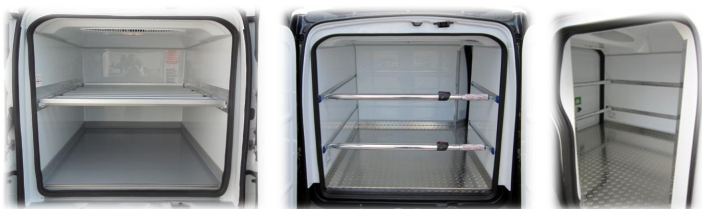
Plancher polyester (version sans PLC), option étage intermédiaire - Plancher aluminium (version avec PLC) - Options rails et barres d'arrêt de charge - Porte latérale coulissante
