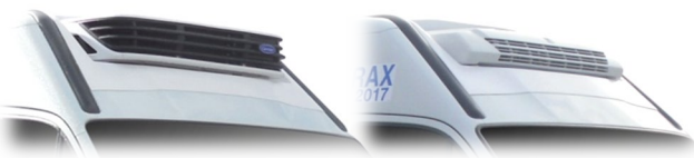
Groupes splités dans encastrement aérodynamique : CARRIER ; THERMOKING
