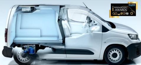
Groupe intégré sous-châssis Kerstner e-Cooljet 106
