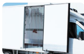
Seitentür rechts mit Temperaturschutzvorhang
