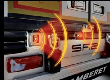
**APROXIMACIÓN ASISTIDA A LA ZONA DE CARGA Y DESCARGA INTEGRADA.** Permite proteger la parte posterior frente a los impactos fuertes. Los sensores por ultrasonidos miden la distancia hasta la zona de carga y descarga y accionan sucesivamente el sistema de freno. Este sistema opcional está plenamente integrado al bastidor y al EBS para garantizar la máxima fiabilidad. Los sensores están protegidos.
