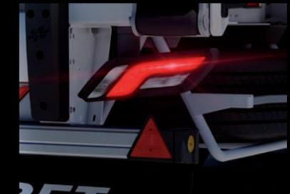
**LUCES GIRATORIAS ANTIGOLPES SAFELIGHT LED.** La nueva patente de Lamberet, 100% LED, ofrece mayor seguridad y ahorro. Sus funciones de iluminación son independientes e intercambiables. Están integradas en una caja carenada estanca, que se puede girar 180° (+90°/-90°), resistente a los impactos y con retorno automático a la posición de carretera.
