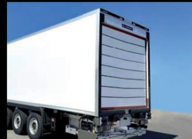
**PERSIANA ISOTÉRMICA Y NEUMÁTICA DISTRI+.** Ideal para la distribución, la persiana Distri+ ofrece apertura automática y cierre asistido. Es 100% neumática y autónoma incluso sin conectarse a la alimentación eléctrica. Con su anchura (2,42 m), su altura de paso optimizada y las guías de corredera encastradas facilita las maniobras de carga y descarga.
