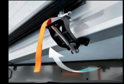
**SISTEMA DE SUJECIÓN DE PUERTA GIRATORIO Y ASISTIDO EDL.** Easy Door Lock, el sistema exclusivo y patentado de Lamberet, ofrece una mayor ergonomía y una manipulación suave e intuitiva, sin riesgos de pinzamiento. El bloqueo del pestillo de cada batiente limita el riesgo de desenganche para ofrecer, de este modo, una seguridad máxima.
