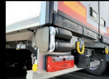
**FERRY SIN ACOMPAÑAMIENTO RO-RO** Para el transporte marítimo, el SR2 dispone de placas de refuerzo delanteras para caballetes, 8 enganches para ferry, caballetes de ruedas, una barra antiempotramiento adelantada con zapatas y marcado para cargas rodadas. De manera opcional, dispone de una barra redonda de umbral, placas antigolpes en las puertas traseras, protección del grupo, interruptor Plataforma/Off/Buque.
