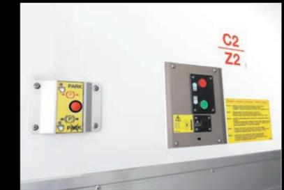
**SUBIDA Y BAJADA AUTÓNOMA Y ADI.** La subida y bajada 100% autónoma de Lamberet de 3 teclas es neumática e independiente de cualquier suministro de energía eléctrica, por lo que puede funcionar sin enganche. El sistema ADI (antideslizamientos inesperados) controla el freno de estacionamiento del semiremolque para garantizar la seguridad de los operarios de la zona de carga y descarga. Dispone de mandos interiores encastrados a mano izquierda.
