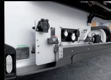
**CONECTORES NEUMATICOS Y ELECTRICOS DESLIZANTE DRYLIN DE LAMBERET.** El soporte está sujeto mediante pernos y protegido frente a los impactos en la parte delantera del bastidor. Se desliza sobre un monorail Drylin sin bloqueo y sin necesidad de mantenimiento. Los riesgos de TME\*\* para el conductor se reducen. El periodo de vida útil de las mangueras se prolonga y se limitan los desgarros. Conectores incluidos 24S, 24N, 15 clavijas. 24N, 15 broches.
