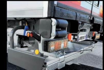
**COMPUERTA TRASERA CON ELEVADOR** Específicamente concebido y reforzado para optimizar la integración de las compuertas, el módulo trasero se puede completar con canaletas que protejan la plataforma en posición de carretera y deflectores antiincrustantes entre el último eje y la compuerta, para evitar que la plataforma se llene de impurezas.
