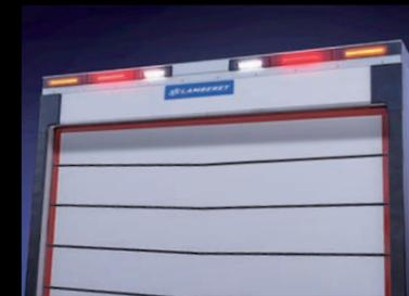
**BARRA DE SEÑALIZACIÓN SAFELIGHT LED** Idealmente instalada en la parte superior del marco, y protegida por los topes, la barra cuenta con los repetidores de los intermitentes y las luces de freno/posición. Garantiza una visibilidad y una seguridad máximas. De manera opcional, se pueden incluir faros de trabajo y una cámara.
