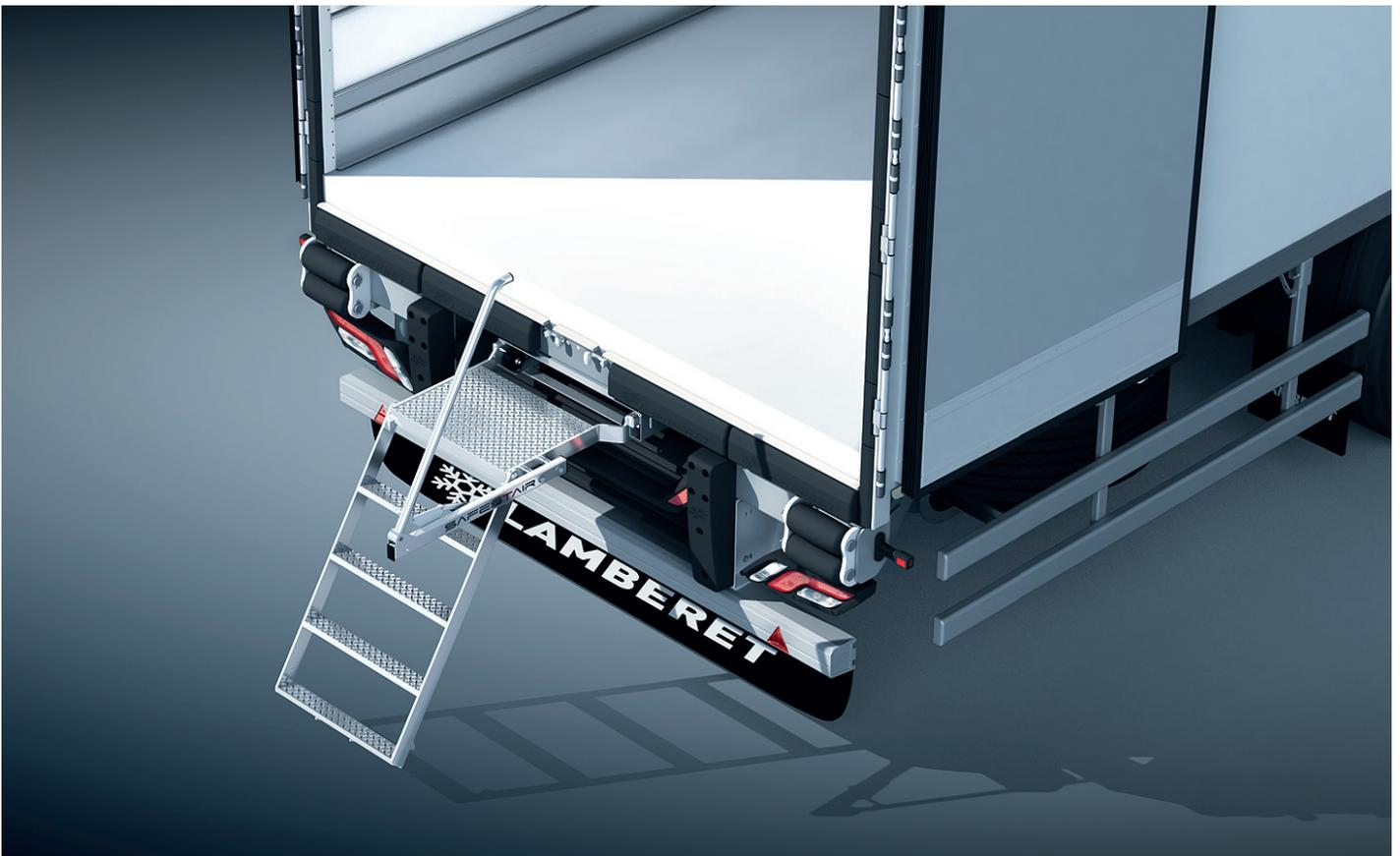
*La barandilla integrada en el SAFESTAIR se despliega automáticamente al extraer la escalera.
