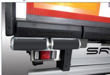
**Sistema de protección integral:** el exclusivo diseño de Lamberet permite respetar el gálibo ferroviario al tiempo que cuenta con una protección reforzada de la parte trasera del chasis, equipada con dobles topes horizontales con rodillos amortiguadores. Las columnas y el umbral están completamente protegidos mediante topes integrados.
