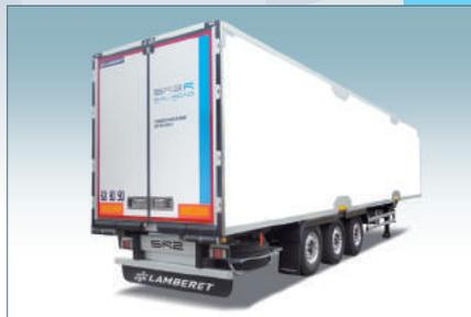
**Estructura posterior HeavyDuty en acero inoxidable:** especialmente concebida para resistir al desgaste provocado por las tareas de distribución intensiva y reforzada con escuadras y cartelas de acero ALE de 12 mm, que absorben los esfuerzos sin concentrarlos en los ángulos.
