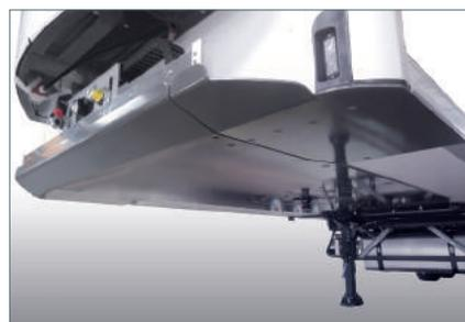
**Placas delanteras ampliadas:** una protección máxima frente a los usos más severos por parte de terceros durante las operaciones de transbordo. De este modo, la cara delantera está protegida de los impactos en todo el ancho.
