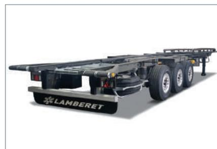
**Rodada del eje adaptada a 2040 mm:** para adaptarse completamente a las limitaciones dimensionales del vagón, la rodada del eje alcanza los 2040 mm. La excelente rigidez del chasis empernado del SR2 permite conservar una altura limitada de los largueros del bastidor y permite bajar el centro de gravedad, ofreciendo el mejor comportamiento en carretera del mercado.
