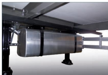
**Máxima autonomía:** gran depósito de aluminio con capacidad para 420 litros. Resistente al envejecimiento y a la corrosión, su excepcional capacidad se combina con la eficacia del aislamiento de materiales compuestos de Lamberet para ofrecer una mayor autonomía. Una gran ventaja para el transporte ferroviario de larga distancia.
