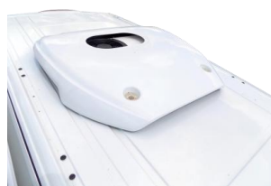
Revestimiento grupo aerodinámico (Versión presentada Carrier - Thermoking)
