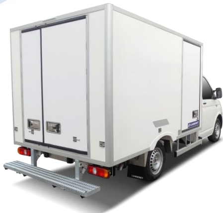
Caja rebajada de tipo piso con cabina con pasos de ruedas opcionales
