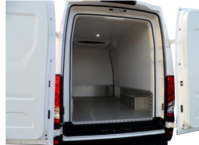
Coffrage aluminium des caissons de roue
