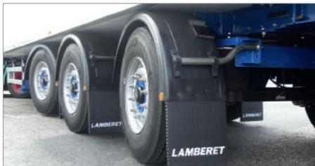
**Longévité pneumatique « best in class » :** La réduction du ripage (diminution d'un facteur 10) liée à l'efficacité du système X-Steering prolonge la durée de vie des pneumatiques de manière significative. Nos tests ont montré que pour une X-City opérée en régional ou distribution urbaine intensive, la longévité des pneumatiques pouvait être multipliée par 4.
