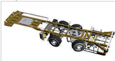
**La hauteur qu'il faut, là ou il faut :** Le mécanisme directeur X-Steering, tourelles et câbles, est totalement intégré de manière transparente au châssis. Les hauteurs de selle de d'attelage, de longerons de châssis (180 mm) et de seuil de chargement sont inchangées. X-City est ainsi compatible avec tous les quais de chargement standard, et son ratio hauteur-hors tout / hauteur de chargement demeure très performant.
