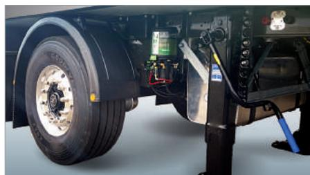
**Easy-maintenance :** Le système d'essieu directeur à câbles est hyper-compétitif en termes de maintenance. Une visite annuelle de vérification suffit à garantir le bon fonctionnement du système. Le graissage est à réaliser tous les 300 000 km seulement, ou à travers un système de graissage centralisé optionnel. Sans électricité ni électronique, c'est un investissement offrant un retour sur investissement très rapide.
