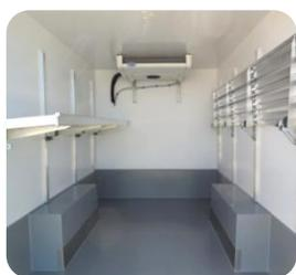
Cette carrosserie est destinée au transport sous température dirigée, en conformité avec la réglementation ATP en vigueur.
