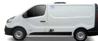
Groupe THERMOKING / CARRIER encastré sous cache aérodynamique
