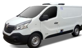
Groupe THERMOKING / CARRIER encastré sous cache aérodynamique
