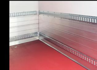
**Rails d'arrimage et lisses (options) :** Les lisses aluminium protègent les parois contre les chocs répétés. Les rails d'arrimage sécurisent et stabilisent vos marchandises lors du transport (disponibles en perforation rondes «aéro» ou mixtes).
