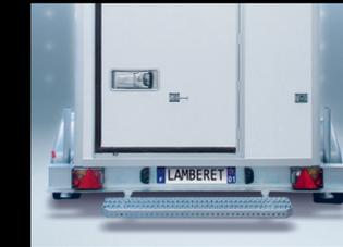
**Marchepied :** Intégré en version 750 kg ou rapporté au châssis en version 1300 et 2000 kg, le marchepied en acier fixe «1 niveau» antidérapant facilite l'accès à la zone de chargement.
