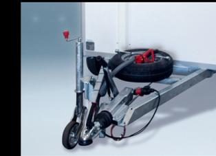
**Accastillage de châssis (série) :** Toutes les remorques sont dotées d'un accastillage complet : roue jockey pour faciliter la traction des manœuvres ; 2 béquilles stabilisatrices à l'arrière et frein de parc pour l'usage statique ou le parking ; roue de secours et manivelle ; prise remorque 13 broches avec adaptateur 7 broches amovible.
