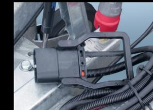
**Raccordement véhicule (mode route) :** En mode route (option), le groupe électrique est raccordé au moyen d'une prise de type «fenwick» à la batterie du véhicule tractant, dont l'alternateur doit disposer de 90 A minimum.
