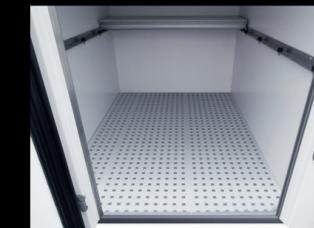
**Caillebotis (option) :** Le plancher est recouvert de dalles plastiques amovibles et ajourées, faciles à laver, afin de bénéficier d'une ventilation optimisée, interdire le contact entre les denrées et le sol et protéger le chargement des eaux de condensation. Recommandé dans le cadre d'une démarche hygiène «HACCP».
