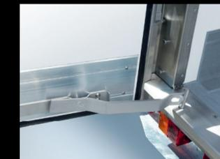
**Arrêt de porte :** Les remorques Lamberet sont dotées d'arrêt de portes (en caoutchouc ou en T, selon modèle). Pour faciliter les opérations dans les zones étroites de stationnement, des arrêts à 100° sur OT2 sont disponibles en option (photo).
