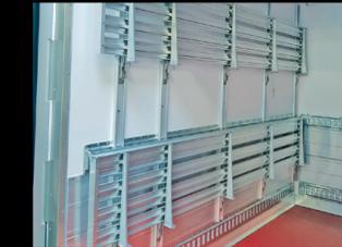
**Étagères réglables et relevables (option) :** Réglables en hauteur et relevables, les étagères sont disponibles sur plusieurs niveaux et 2 profondeurs (400 ou 500 mm). 100% aluminium (anticorrosion) elles sont sécurisées en position relevée par des goupilles mécaniques.
