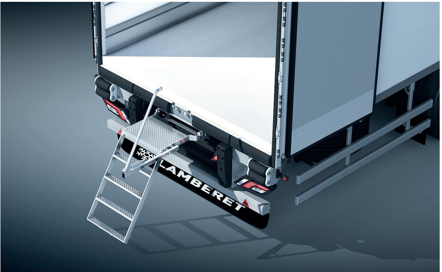
*La rampe intégrée au SAFESTAIR se déploie automatiquement lors de l'extraction de l'échelle.
