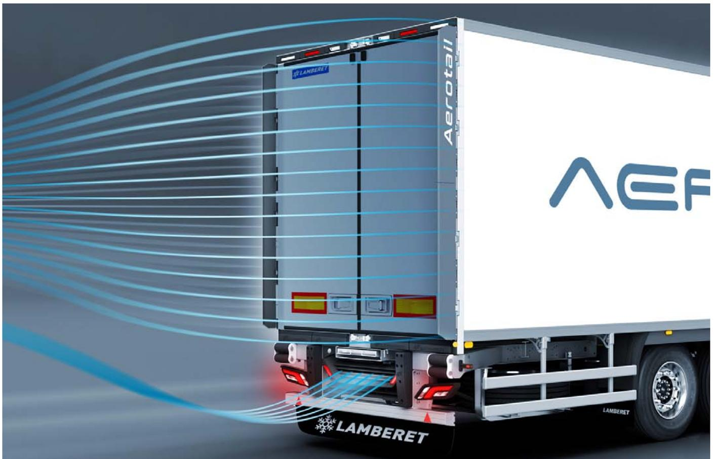
Les AÉROTAILS sont les premiers spoilers arrière dont le fonctionnement est totalement automatique. Le gain de consommation constaté est de 1% minimum en conditions mixtes.
