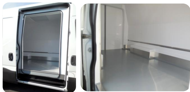
Porte latérale coulissante isolée avec double joint périphérique
