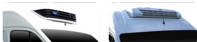
Groupes splités avec encastrement aérodynamique
