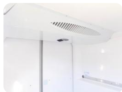
Zone de chargement avec évaporateur
