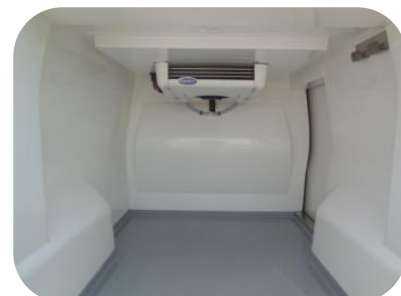
Zone de chargement avec évaporateur
