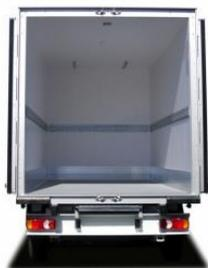
Cette carrosserie est destinée au transport sous température dirigée, en conformité avec la réglementation ATP en vigueur.
