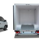
Cette carrosserie est destinée au transport sous température dirigée, en conformité avec la règlementation ATP en vigueur.
