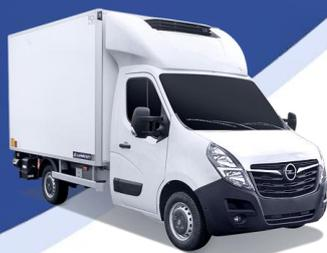
Cette carrosserie est destinée au transport sous température dirigée, en conformité avec la réglementation ATP en vigueur.
