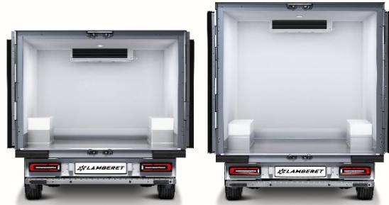
Cette carrosserie est destinée au transport sous température dirigée, en conformité avec la réglementation ATP en vigueur.
