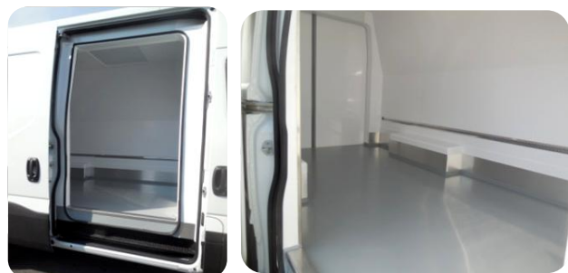
Porte latérale coulissante isolée avec double joint périphérique
