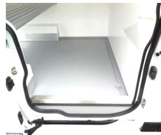
Porte latérale avec protection de seuil inox.
