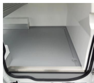
Porte latérale avec protection de seuil inox
