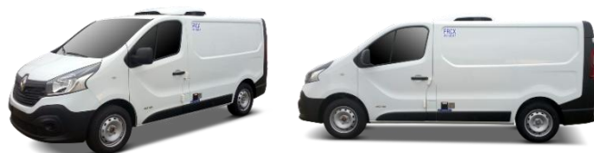
Groupe THERMOKING / CARRIER encastré sous cache aérodynamique
