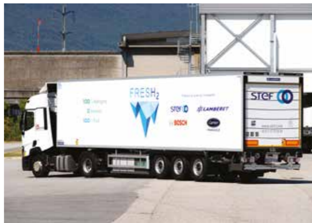
Les essais en conditions réelles avec le transporteur STEF sont concluants: la technologie de PAC H2 directe BOSCH a permis d'assurer dans la durée des tournées de distribution en multi-température.
